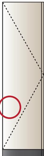
※長尺ボックスの場合は開く側の下から1/3程度の箇所を手の平でグッと押し込んでください。
