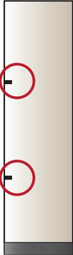
※長尺ボックスの場合は上下二つのプレート部を手の平でグッと押し込んでください。
