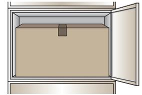
③カチカチと音が鳴ったタイミングで、押さえていた手の平をパッと離していただくと、扉の突っ張りが外れ開錠する事ができます。
