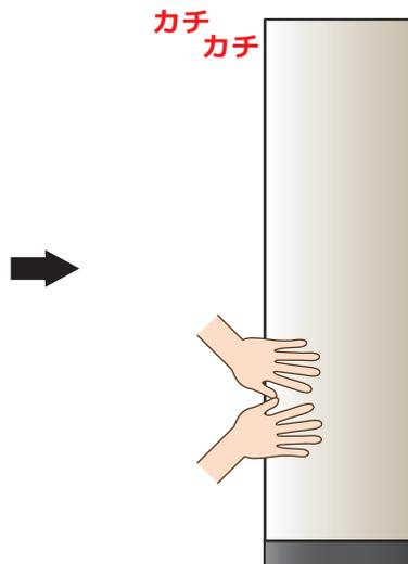
※手の平で強く押しこんでカチカチの音に合わせて離します。
